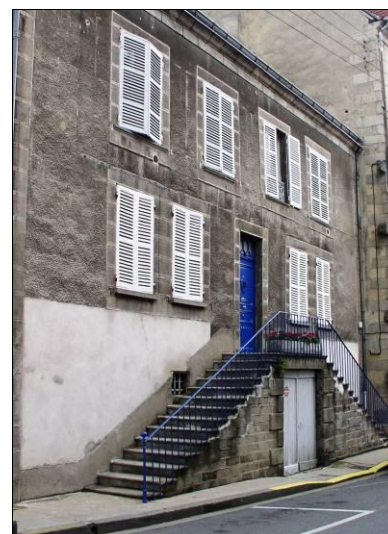
Escalier extérieur en pierre, à double volée droite, palier central, sous lequel se trouve l'entrée de la remise. 3 rue Jean Jaurès.
