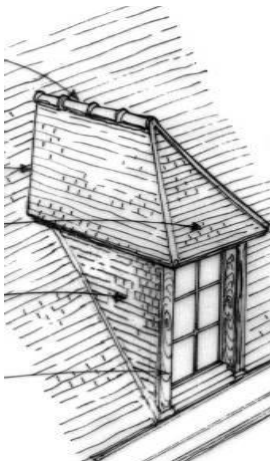
Lucarnes capucines rue Alfred Assolant. Couvertes en petites tuiles, arêtiers profilés au mortier, faîtage en tuiles demi-rondes. Joues bardées de châtaignier.
